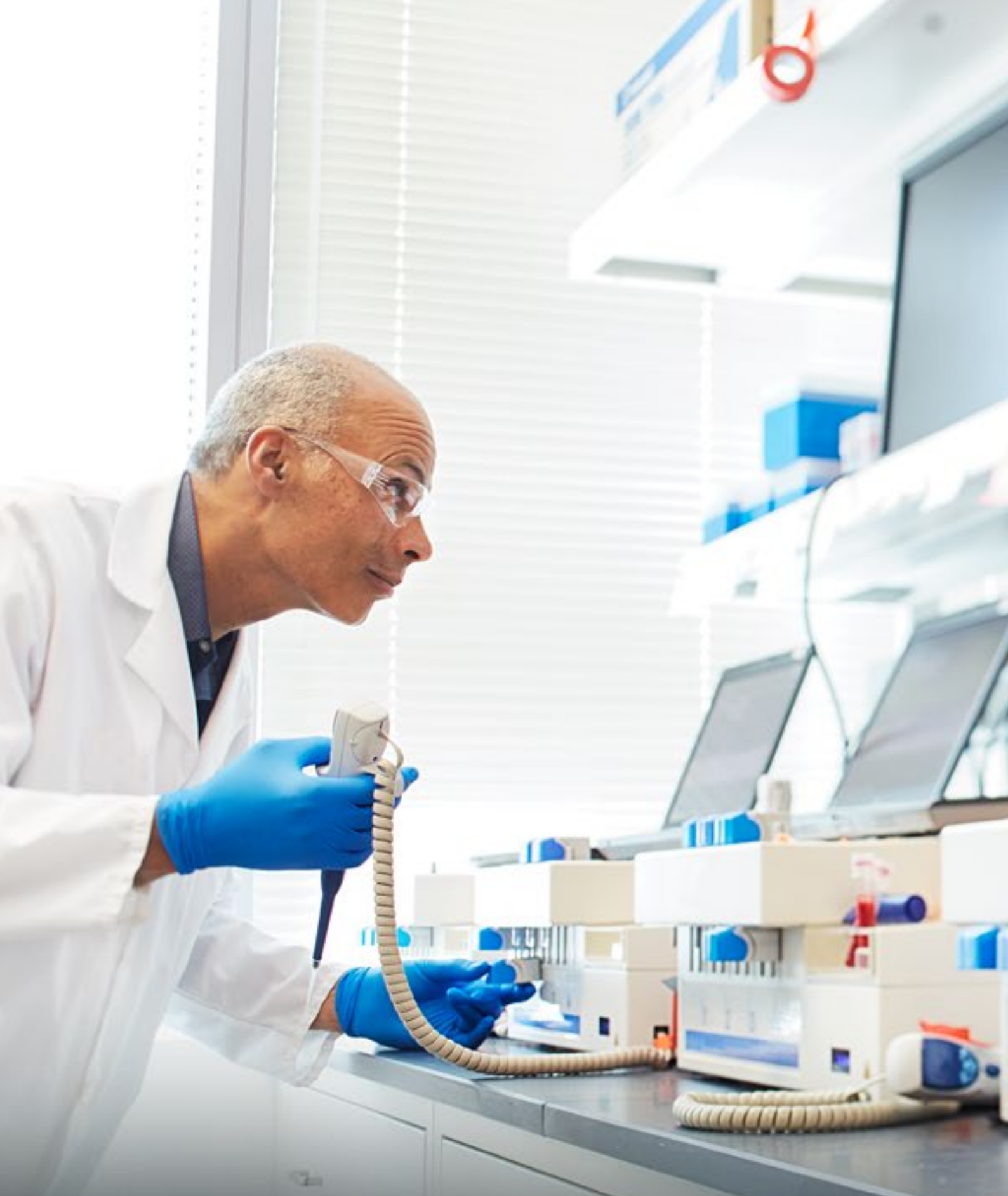
Labortest: Bayer-Forscher Philip Ramsey untersucht Blutproben an einem Gerät für Gerinnungsdiagnostik auf mögliche Blutgerinnsel. Er will herausfinden, wieso bei manchen Menschen das Gleichgewicht aus Gerinnungsfaktoren und Gerinnungshemmern gestört ist.
