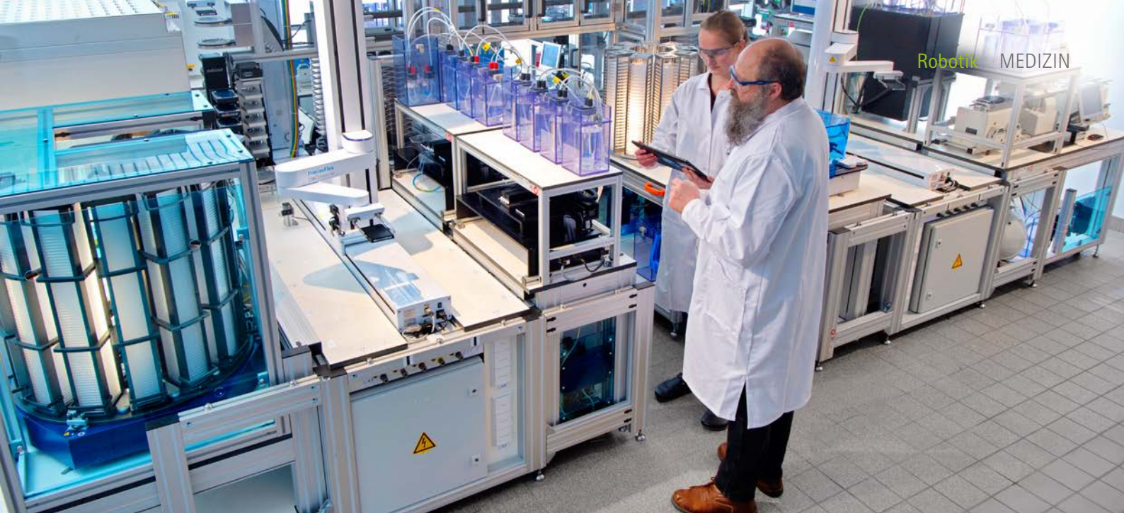
Ein Krake mit vier Armen: Die einzigartige Anlage kann die gesamte Bayer-Substanzbibliothek mit 4,1 Millionen Molekülen innerhalb weniger Tage screenen. Bayer-Mitarbeiter Georg Schmidt konstruierte den Kraken, neben ihm steht seine Kollegin Maike Günther.
