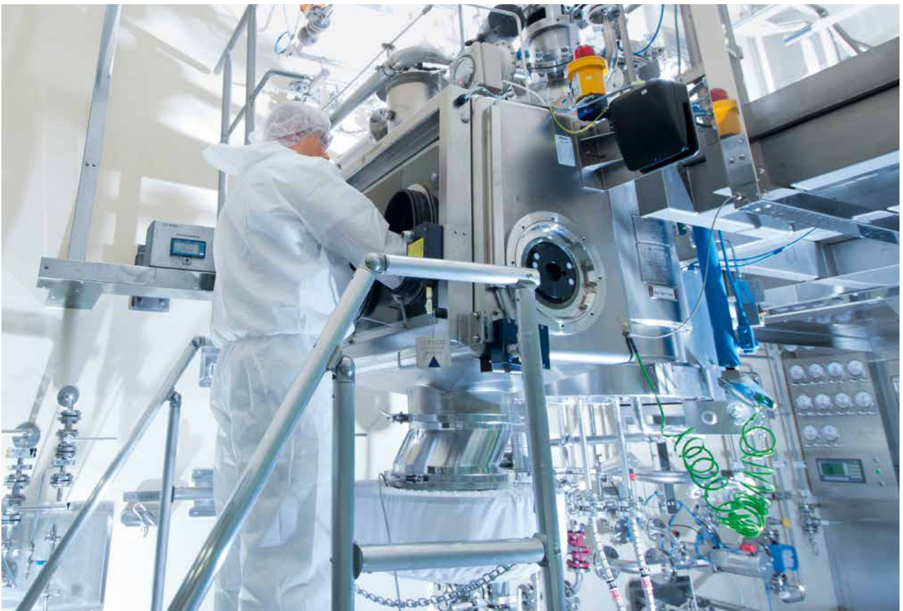
Reinheitsgebot: Adam Mikolasch füllt einen hochaktiven Wirkstoff staubfrei und hermetisch über ein Endlosschlauchsystem ab.
