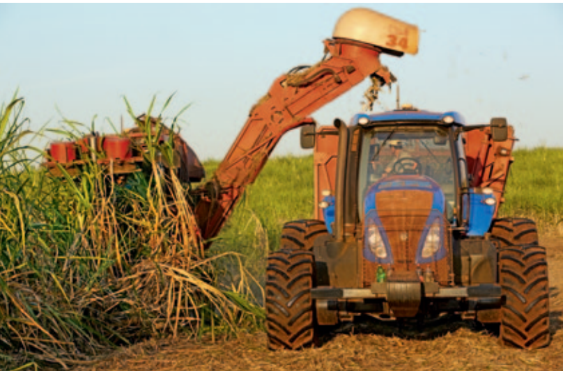
Ernte unter Kontrolle: Die modernen Zuckerrohr-Erntemaschinen in Brasilien sind GPS-gesteuert. So soll verhindert werden, dass unnötig Boden oder Erträge zerstört werden.
