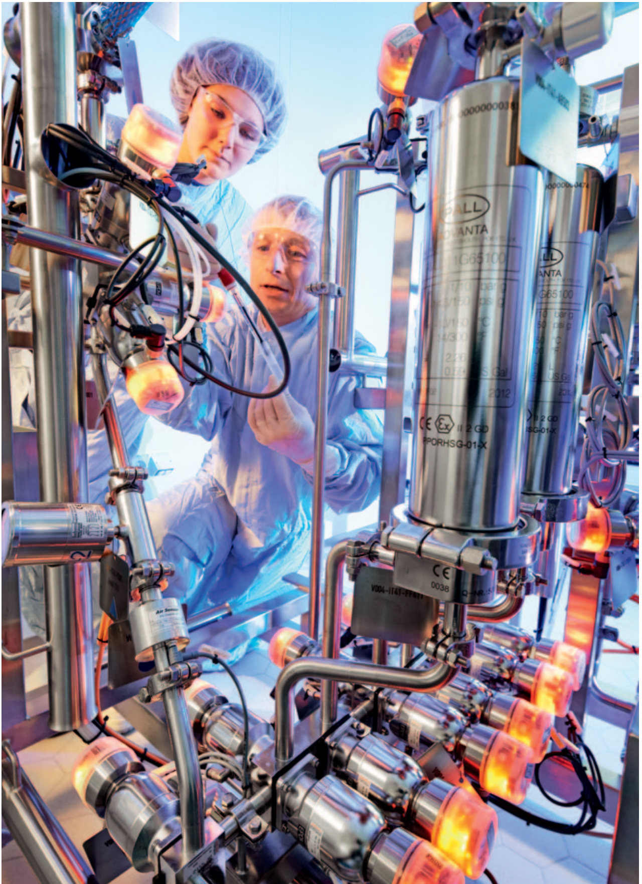
Optimale Prozesskette: Jennifer Tummes und Philipp Ehrsam (v. li.) prüfen eine pH-Sonde am Fermenter, in dem Zellen Biologika produzieren.
