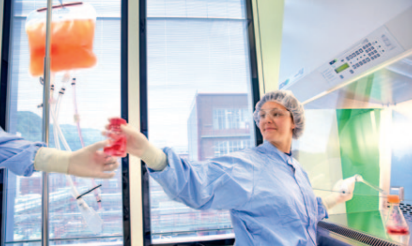
Saubere Arbeit: Unter der Sterilbank nimmt Jennifer Tummes (Foto links) kleine Proben der Proteinlösung und analysiert diese anschließend im Reinraum. Denn bereits kleinste Verunreinigungen wie geringe Mengen von Bakterien oder Pilzfäden könnten die gesamte Charge unbrauchbar machen. Auch Thomas Lettner (Foto rechts) arbeitet völlig steril und mit Handschuhen in einem Isolator, wenn er die reine Antikörper-Lösung für die klinischen Studien vorbereitet.
