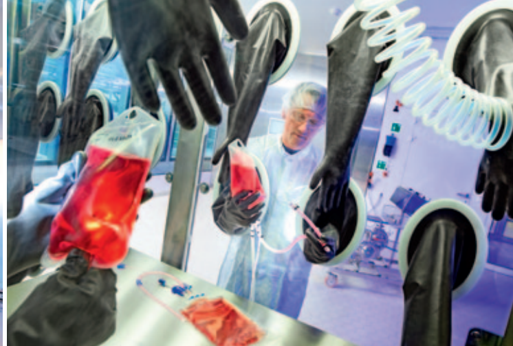
Saubere Arbeit: Unter der Sterilbank nimmt Jennifer Tummes (Foto links) kleine Proben der Proteinlösung und analysiert diese anschließend im Reinraum. Denn bereits kleinste Verunreinigungen wie geringe Mengen von Bakterien oder Pilzfäden könnten die gesamte Charge unbrauchbar machen. Auch Thomas Lettner (Foto rechts) arbeitet völlig steril und mit Handschuhen in einem Isolator, wenn er die reine Antikörper-Lösung für die klinischen Studien vorbereitet.
