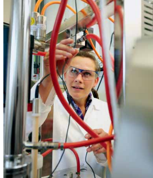
Biotechnologin mit Durchblick: Laborleiterin Dr. Ulrike Hänsel überprüft die Schläuche, die die Bakterien im Fermenter optimal mit Sauerstoff und anderen Nährstoffen versorgen.
