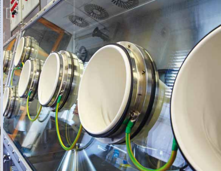
Antikörper-Produktion: Im Sonderlabor für hochaktive Wirkstoffe stellt Dr. Joachim Krüger (Foto li.) in der Chemischen Entwicklung bei Bayer HealthCare das Zellgift MMAE her. In Krügers Labor wird es anschließend auch fest an den Antikörper gekoppelt. Dazu dient eine Glovebox (Foto re.), in der die Substanzen – von Umgebungseinflüssen abgeschirmt – bearbeitet werden können.
