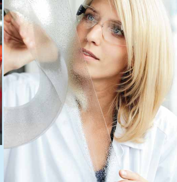
Prüfstationen: Beim ProteXXion®-Sicherheitssystem tastet der Laser (li.) die Lage der in einer Folie eingebetteten Metallplättchen ab und vergleicht das Muster mit einer Datenbank. Die Laborantin Kira Planken (re.) begutachtet die Qualität der eingesetzten transparenten Kunststoffolie Makrofol®, die nur etwa 100 Mikrometer dick ist.
