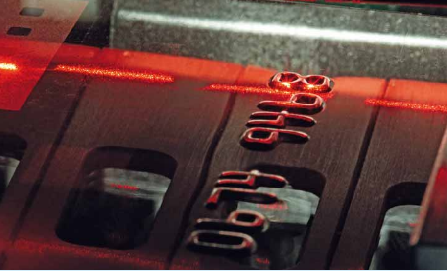
Prüfstationen: Beim ProteXXion®-Sicherheitssystem tastet der Laser (li.) die Lage der in einer Folie eingebetteten Metallplättchen ab und vergleicht das Muster mit einer Datenbank. Die Laborantin Kira Planken (re.) begutachtet die Qualität der eingesetzten transparenten Kunststoffolie Makrofol®, die nur etwa 100 Mikrometer dick ist.
