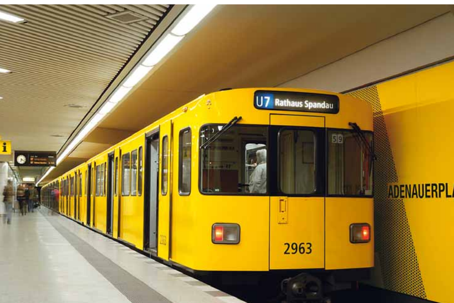
Mobil mit PUR-Sandwich: Verbundelemente aus Polyurethan und eingelagerten Glasfasern sorgen in der Dachkonstruktion von U-Bahn-Waggons im Berliner Untergrund für Gewichtsersparnis und hohe Stabilität. Das Sandwich-Bauteil ist extrem leicht und trotzdem steif.
