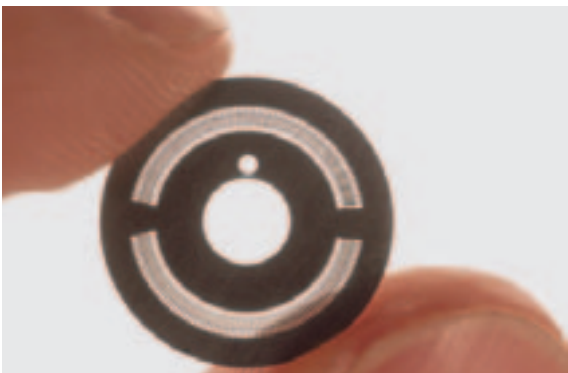
Fingernagelgroß: Schlitzplatte eines Mikromischers (s. Abb. oben auf dieser Seite).
